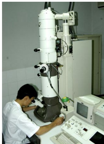
Hình 22.11: Kiểm tra dưới kính hiển vi điện tử
